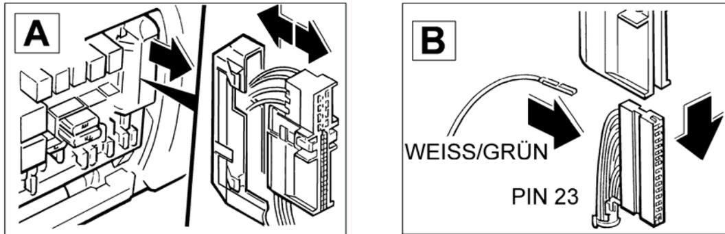
Multitimer in umgekehrter Reihenfolge wieder montieren und auf die Zentralelektrik stecken.
